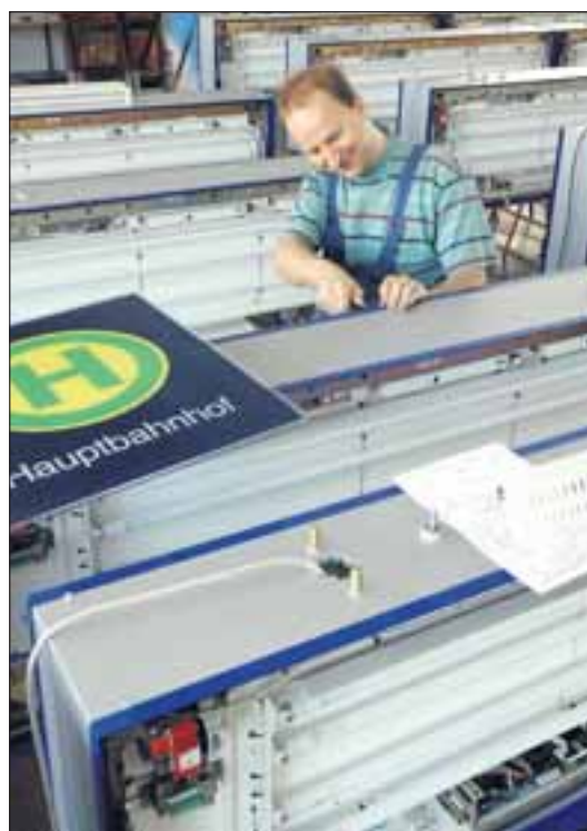
Spezialisierte Montage: SaF-Mechaniker Karsten Clobes setzt Anzeigetafeln zusammen.
